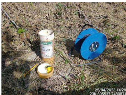
Foto 7 – Leitura de nível d'água no PM-BP-07. (Data: 25/04/2023).
