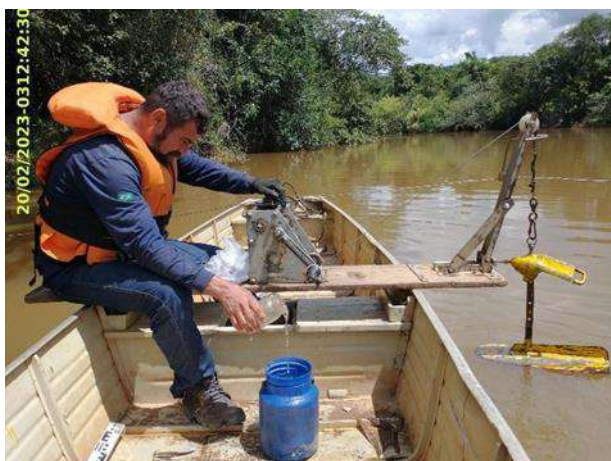
Foto 3 – Descarga sólida no PHM. (Data: 20/02/2023).
