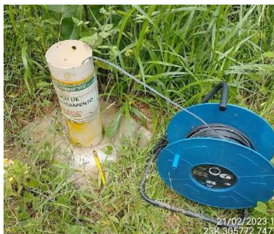
Foto 4 – Leitura de nível d'água no PM-BP-01. (Data: 21/02/2023).
