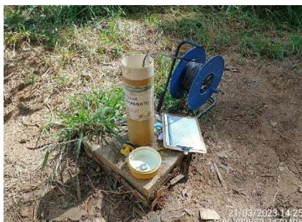
Foto 3 – Leitura de nível d'água no PM-BP-11. (Data: 21/02/2023).
