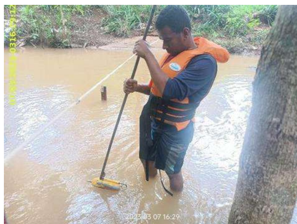
Foto 6 – Coleta de sedimentos no PSED. (Data: 07/03/2023).
