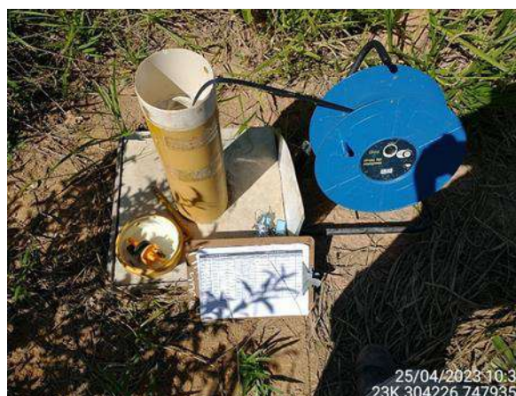
Foto 8 – Leitura de nível d'água no PM-BP-11. (Data: 25/04/2023).
