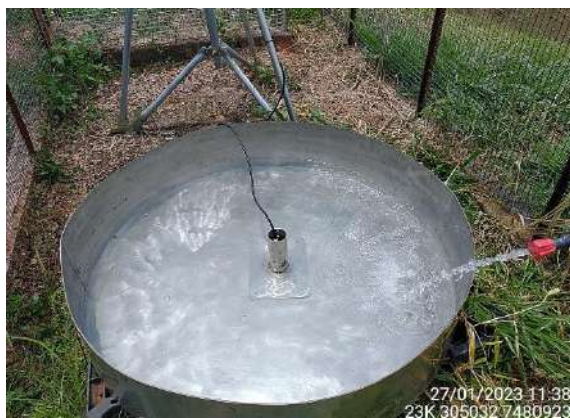
Foto 1 – Realização da atividade de limpeza da EMA. (Data: 27/01/2023).
