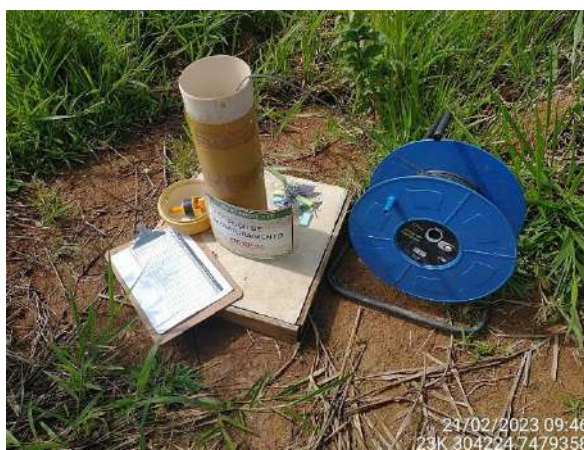
Foto 3 – Leitura de nível d'água no PM-BP-11. (Data: 21/02/2023).
