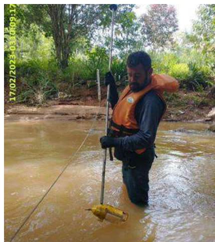
Foto 4 – Medição de Descarga sólida no PSED. (Data: 17/02/2023).
