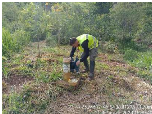
Foto 1 – Leitura de nível d'água no PM-BP-10. (Data: 11/01/2023).
