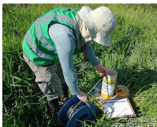
Foto 4 – Leitura de nível d'água no PM-BP-01. (Data: 21/02/2023).
