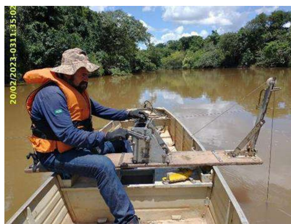
Foto 2 – Medição da descarga líquida no PHM. (Data: 20/02/2023).
