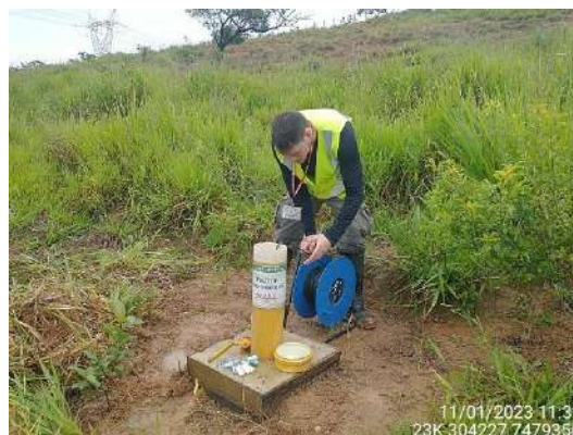
Foto 2 – Leitura de nível d'água no PM-BP-11. (Data: 11/01/2023).
